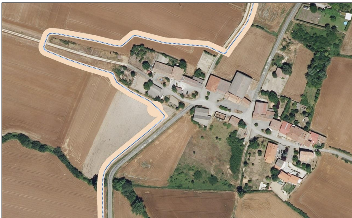
Figura 14.- Detalle del trazado (línea azul discontinua) y área de máxima ocupación (naranja) de la línea de conexión entre las diferentes “islas” que componen el parque solar fotovoltaico “FV Ubalza II” a su paso por el casco urbano del concejo de Gazeo (municipio Iruraiz-Gauna).
