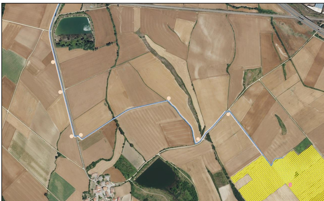
Figura 13.- Línea de conexión entre las diferentes “islas” (polígono amarillo) que componen el parque solar fotovoltaico “FV Ubalza II” en el sector sur (línea azul discontinua) y área de ocupación temporal de las obras de instalación de dicha línea (naranja).
