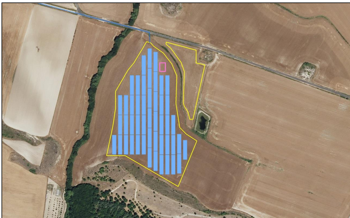
Figura 24.- Distribución espacial de los módulos en la “isla” PV4 (azul), centro de transformación (rosa) y vallado perimetral (amarillo).
