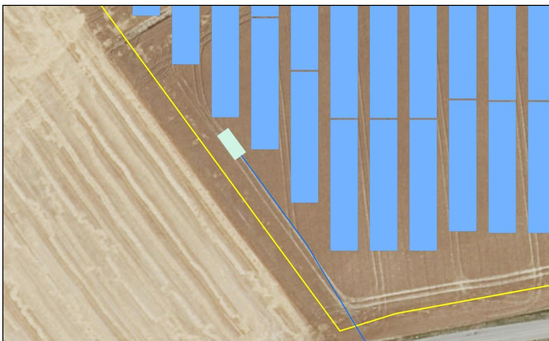
Figura 32.- Detalle de la ubicación del Centro de seccionamiento (RMU) en la isla PV5 (polígono verde).
