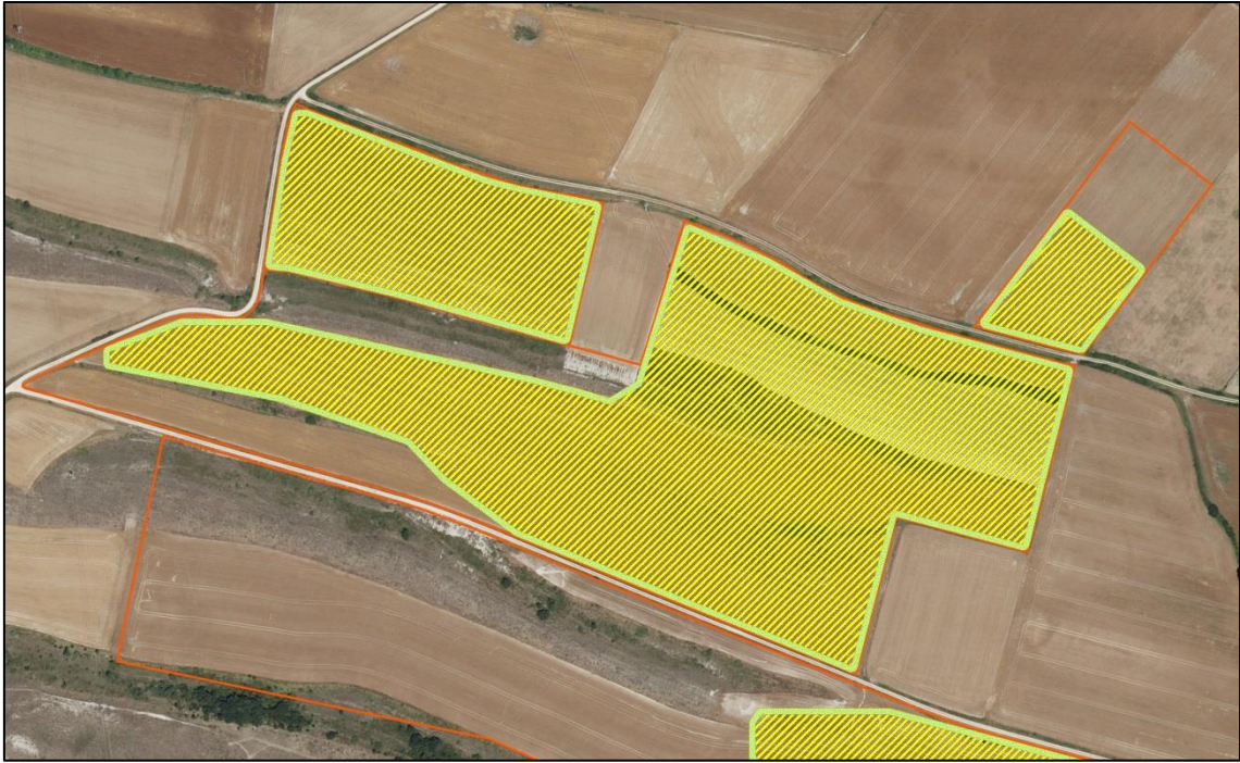
Figura 124.- Vallado perimetral del sector PV 1 de la instalación fotovoltaica “FV Ubalza II” (amarillo rallado), límite de las parcelas (rojo) y banda perimetral de 5 m objeto de restauración (verde).
