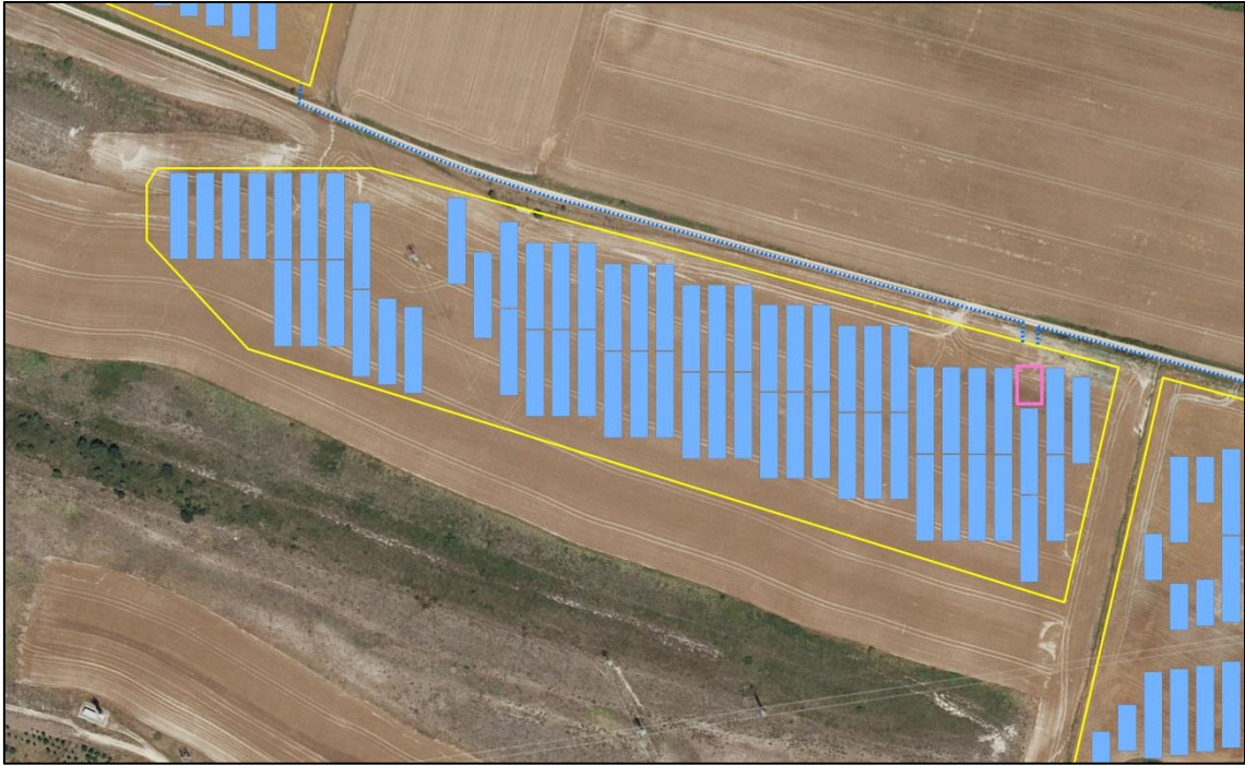
Figura 22.- Distribución espacial de los módulos en la “isla” PV2 (azul), centro de transformación (rosa) y vallado perimetral (amarillo).
