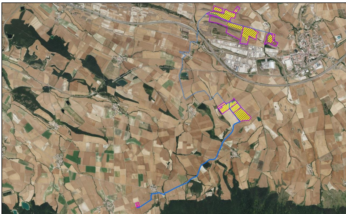
Figura 2.- Ubicación del proyecto de instalación fotovoltaica “FV Ubalza II”: planta solar (amarillo); línea de conexión entre los sectores que componen la planta solar (línea azul discontinua), línea de evacuación (línea azul continua), subestación colectora “San Millán” – ajena al proyecto- (polígono rosa).
