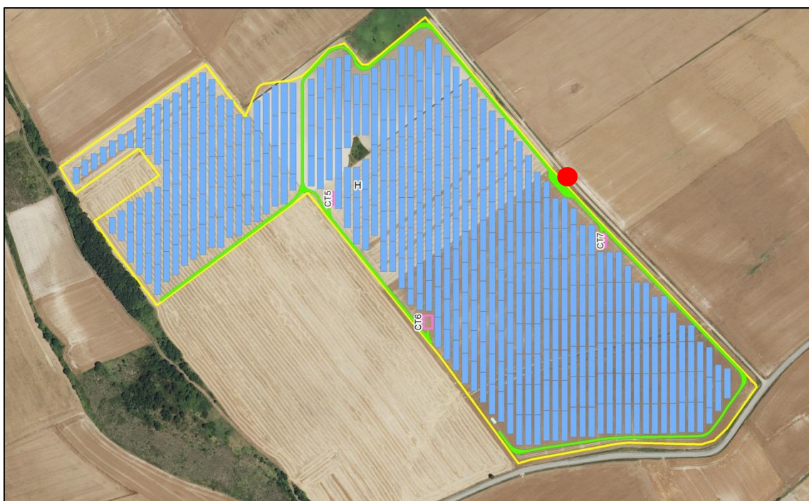
Figura 57.- Caminos internos en el sector PV 5 (línea verde), acceso al parque (punto rojo), instalaciones auxiliares (parque de maquinaria y zonas de acopio de materiales –verde-, centros de transformación –rosa).
